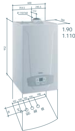
Odvod spalín a prívod vzduchu Ø 110/160 mm SC: Odvod kondenzátu (Ø 24 mm) GAS: Prívod plynu G 1" MR: Výstup ÚK G 1 1/2" RR: Spiatočka ÚK G 1 1/2"
