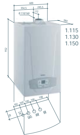
Odvod spalín a prívod vzduchu Ø 110/160 mm SC: Odvod kondenzátu (Ø 24 mm) GAS: Prívod plynu G 1" MR: Výstup ÚK G 1 1/2" RR: Spiatočka ÚK G 1 1/2"
